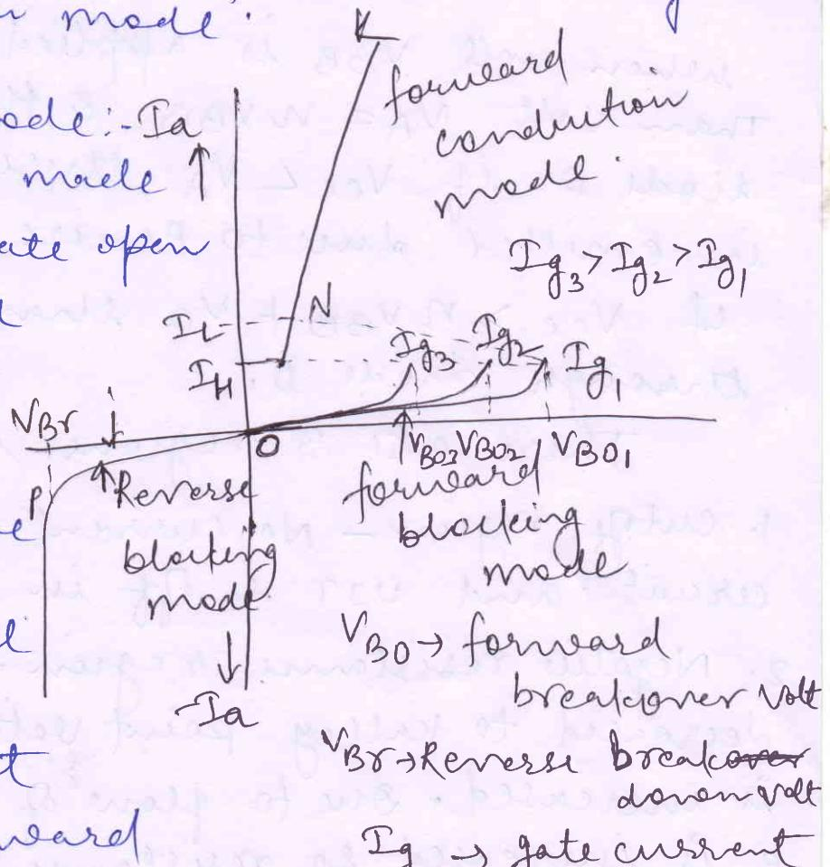
$V_{BO} \rightarrow$  forward breakdown volt
