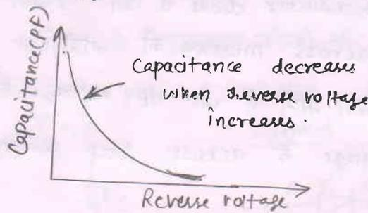
इस तरह एक varactor diode एक variable capacitor की तरह behave करता है। इसका उपयोग frequency multipliers, parametric amplifiers और voltage controlled oscillators में किया जाता है।
