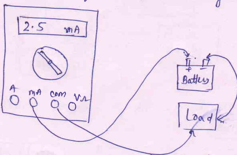
DC current measured करने के लिए DC current range को rotary switch से select करते हैं। Black probe को COM से और red probe को ampere jack से fixed करते हैं। Red probe को battery के positive terminal से और black probe को load से connect करते हैं जिससे पथ complete हो जाता है। तो यह DC current LCD display by show हो जाता है।
