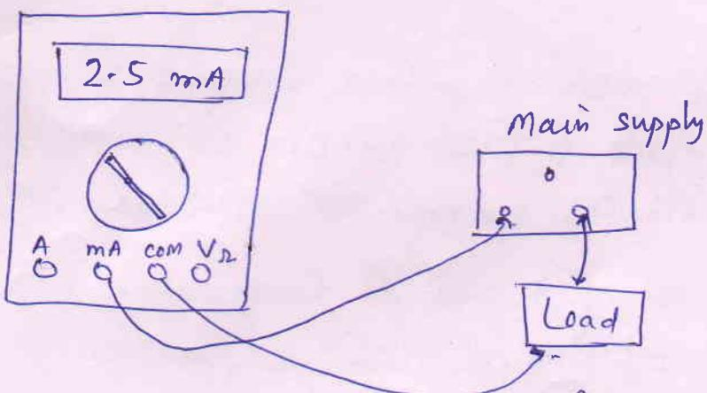
AC current measured करने के लिए AC current range को rotary switch से select करते हैं। Black probe को COM से और red probe को ampere jack से fixed करते हैं। Red probe को main supply से और black probe को load से connect करते हैं जिससे पथ complete होता है। तो यह AC current LCD display पर show हो जाता है।
